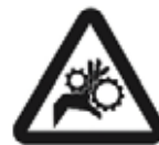
Peligro de arrastre
