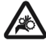
Peligro de arrastre
