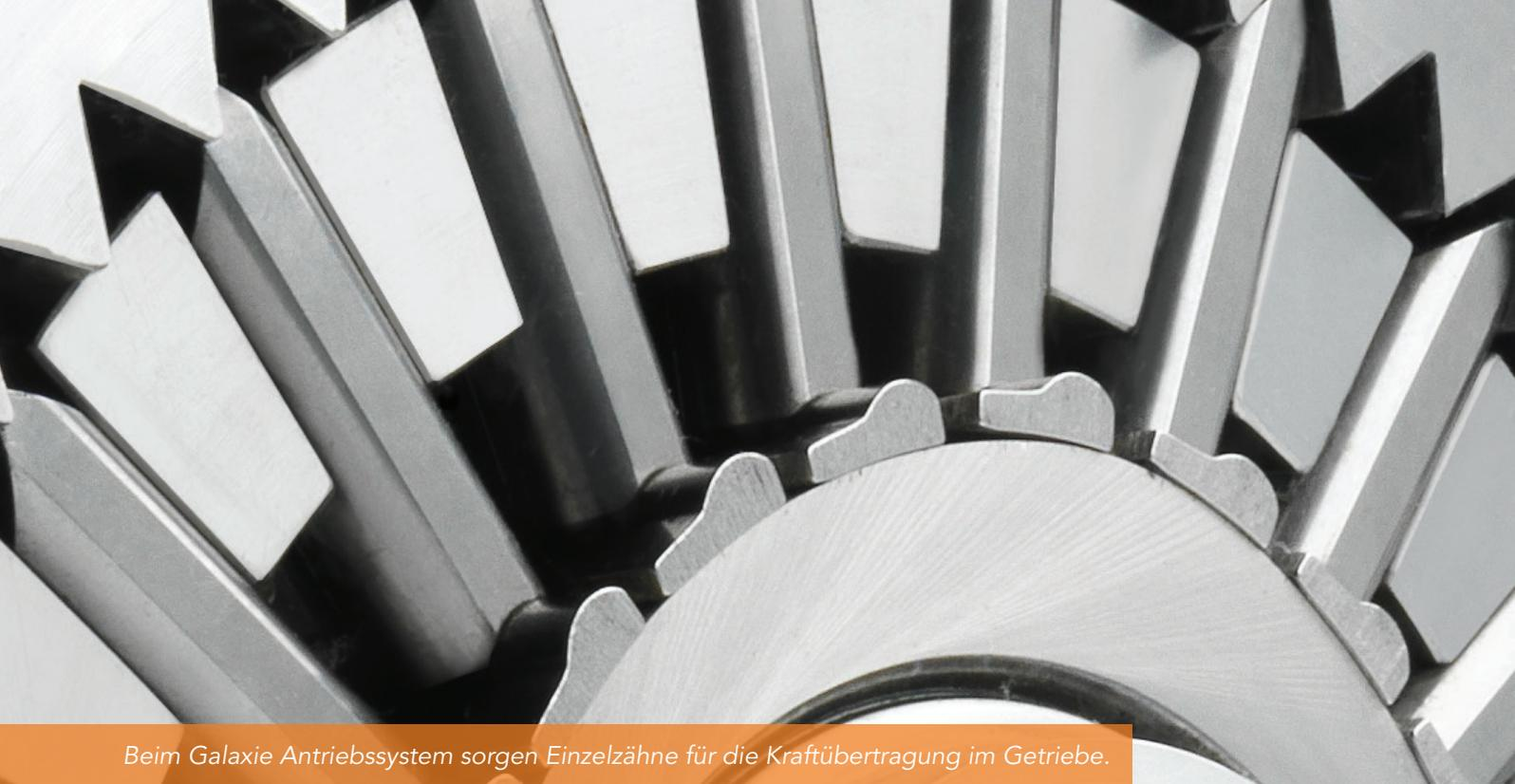
Beim Galaxie Antriebssystem sorgen Einzelzähne für die Kraftübertragung im Getriebe.
