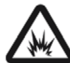
Pericolo di esplosione
