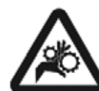
Peligro de arrastre
