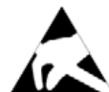
Componente a rischio di carica elettrostatica
