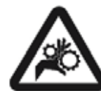
Peligro de arrastre
