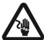
Rischio di elettrocuzione
