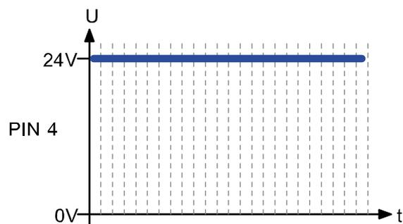
Ein permanent und dauerhaft vorliegender high-Signal (+24V) an PIN 4 bedeutet, dass **ein** Fehler vorliegt.
