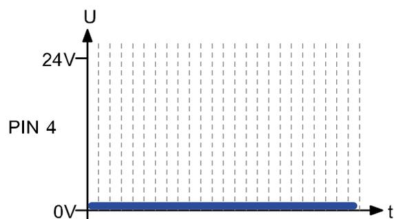
Ein permanent und dauerhaft vorliegender low-Signal (0V) an PIN 4 bedeutet, dass **kein** Fehler vorliegt.
