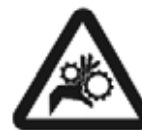
Peligro de arrastre
