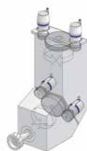
premo® XP Line sulla testa di fresatura di un centro di lavorazione
