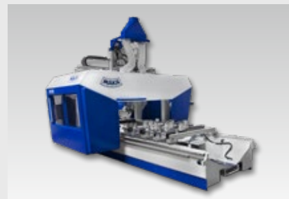
Centre d'usinage CNC pour le bois, le plastique et les matériaux composites Source : MAKAS Systems GmbH
