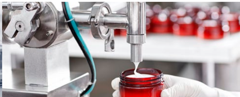
Производство косметики — установка для розлива кремов
