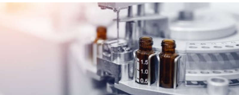
Industria farmaceutica – impianto di riempimento per prodotti farmaceutici liquidi
