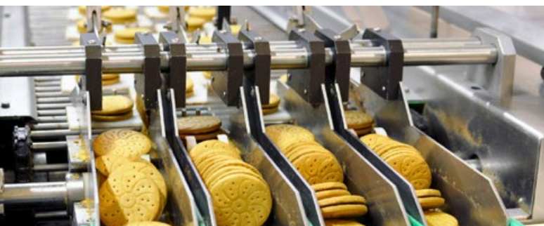
Industria alimentaria – Instalación de envasado para galletas
