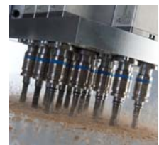
WITTENSTEIN tool drives: Mechatronischer Systembaukasten für die CNC-Holzbearbeitung
