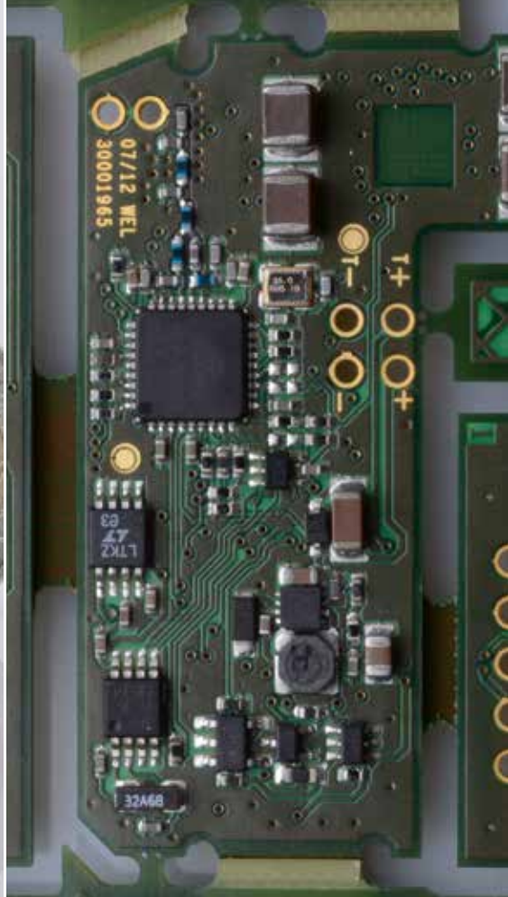
Bestückte Oberseite der Leiterplatte mit abtrennbarer Teststruktur
