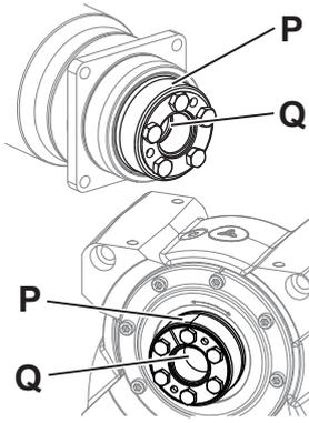
El eje de inserción / el eje hueco / la interfaz de eje hueco se fijan axialmente al eje de carga mediante una unión por anillo de contracción. Si Ud. ha solicitado un reductor con anillo de contracción [P], éste viene ya montado.
