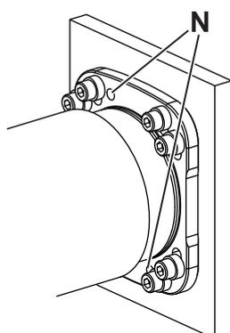
En la carcasa del reductor hay dos orificios [N] para unir el reductor a la máquina. El reductor podrá fijarse a la máquina con pasadores cilíndricos.
