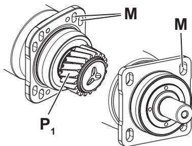
De forma opcional, el reductor puede estar equipado con un piñón de salida [P<sub>1</sub>]. El juego entre los dientes del piñón de salida y la cremallera / rueda conjugada puede ajustarse con los agujeros colisos [M] y las guías laterales. No se necesita ningún dispositivo de ajuste adicional.
