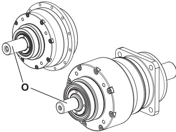
① **Solo** en la variante de reductor "Versión separada" con eje de accionamiento [O] no está previsto **ningún** montaje al motor. El eje de accionamiento ofrece la posibilidad de poder accionar el reductor directamente, por ejemplo, con una polea de correa.
