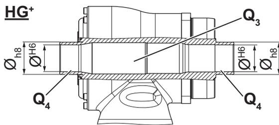
En el eje hueco / interfaz de eje hueco, las piezas vulnerables [Q<sub>3</sub>] deben protegerse contra medios agresivos.
