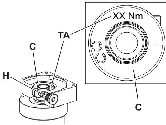
El valor del par de apriete [TA] del tornillo inmovilizador [H] consta en el mismo cubo de fijación [C].
