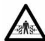
Peligro de aplastamiento
