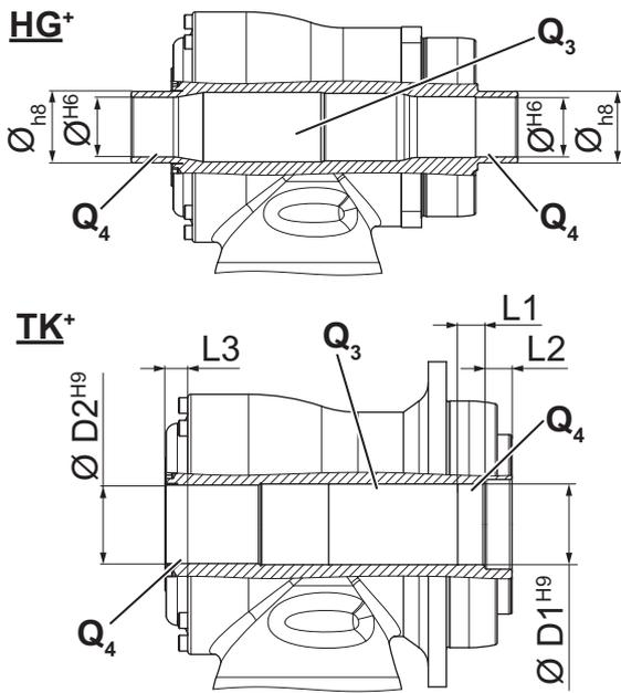
中空軸 / 中空軸インターフェースでは、未保護のパーツ [Q<sub>3</sub>] を侵襲性の高い媒体から保護する必要があります。
