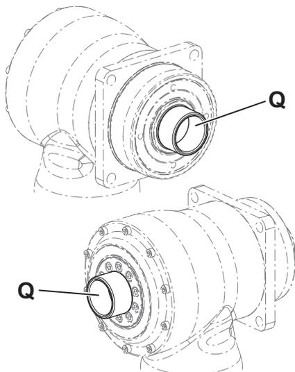
シュリンクディスクは、取り付け軸 / 中空軸 / 中空軸インターフェース [Q] を用いて減速機を荷重軸に固定するのに役立ちます。
