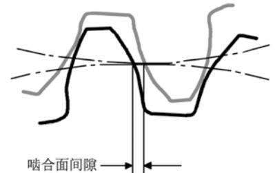
扭转回程间隙是在固定输入轴时测量的。
