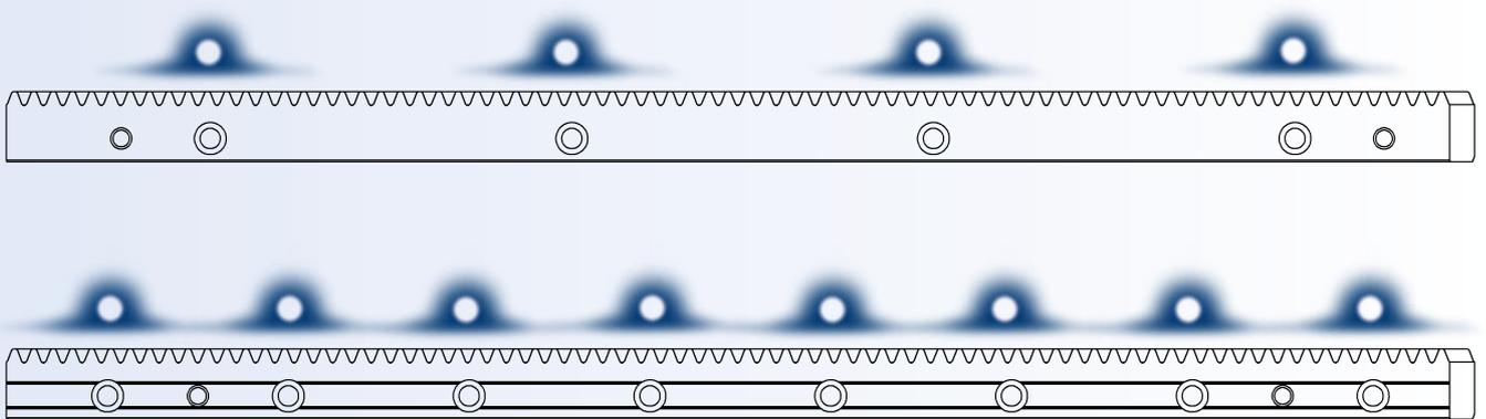
技术测试中使用常规和优化螺孔间距的压力测量膜来确定压力分布。
