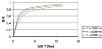
WITTENSTEIN alpha 始终测量齿轮箱在满载运行期间的效率。如果输入功率或力矩降低，因为空载力矩恒定，则效率额定值也会降低。因此，不会增加能量损失。在高速下也会降低效率（参见图示）。
