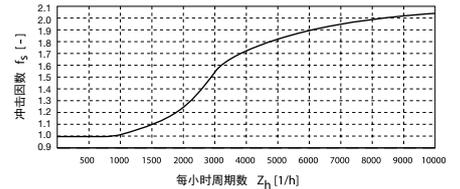
此计算值乘以实际加速力矩  $T_{2b}$ ，然后与最大允许加速力矩  $T_{2B}$  进行比较。 ( $T_{2b} \cdot f_s = T_{2b, fs} < T_{2B}$ )
