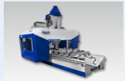
Centro de procesamiento CNC para madera/ material compuesto/plástico Fuente: MAK Systems GmbH
