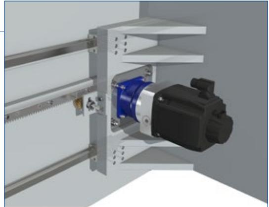
Le système Advanced Linear avec **TP+** ou **TP+ HIGH TORQUE** et les versions angulaires associées peuvent être utilisés comme entraînement individuel, mais aussi comme entraînement maître/esclave dans la plage jusqu'à 21 000 N/entraînement.
