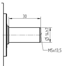
Brida de salida B5 intercambiable
