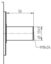
Brida de salida B5 intercambiable
