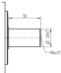
Brida de salida B5 intercambiable
