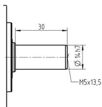
Brida de salida B5 intercambiable
