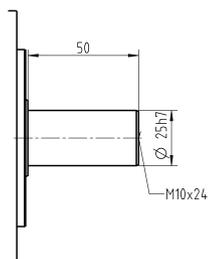
Brida de salida B5 intercambiable
