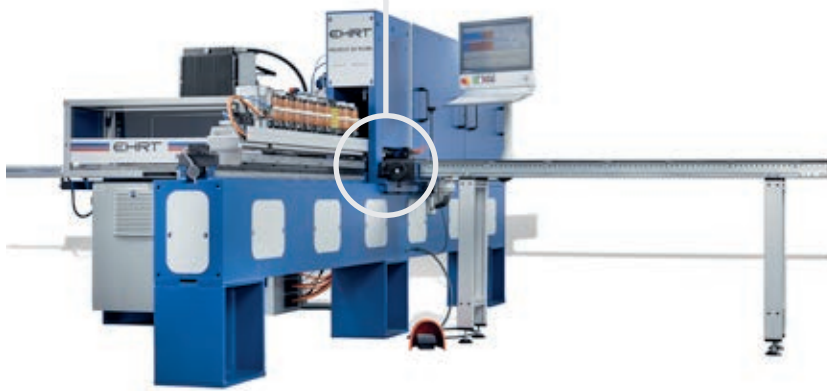
Das von EHRT Maschinenbau und WITTENSTEIN cyber motor gemeinsam entwickelte Antriebsmodul für den Gewindeformer ist nicht alleine für CNC-Stanzmaschinen interessant.
