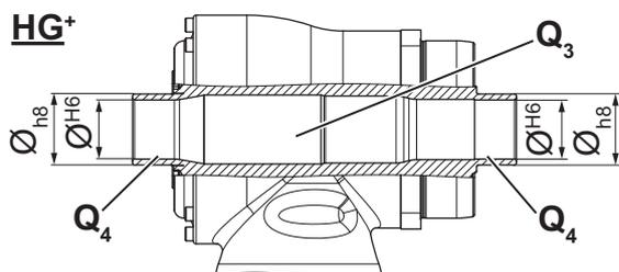
Dans l'arbre creux / l'interface d'arbre creux, les parties exposées [Q<sub>3</sub>] doivent être protégées des liquides agressifs.
