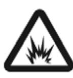
Pericolo di esplosione
