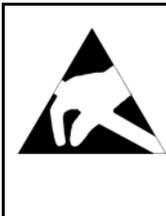
**L'amplificateur d'entraînement contient des éléments de construction sensibles à l'électricité statique qui peuvent être endommagés par une manipulation incorrecte.**
