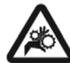
Peligro de arrastre
