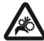
Peligro de arrastre
