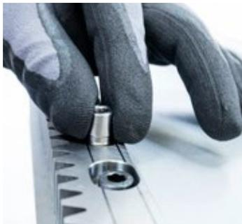
据付ピンは完全に組み立て済みのラックに挿入します。
