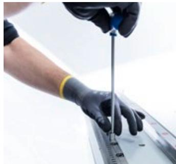
据付スリーブと据付ピンは反対方向に、スリーブがピン穴の中で噛み合うまで回され、その後に2番目の目印まで手で押し入れます。
