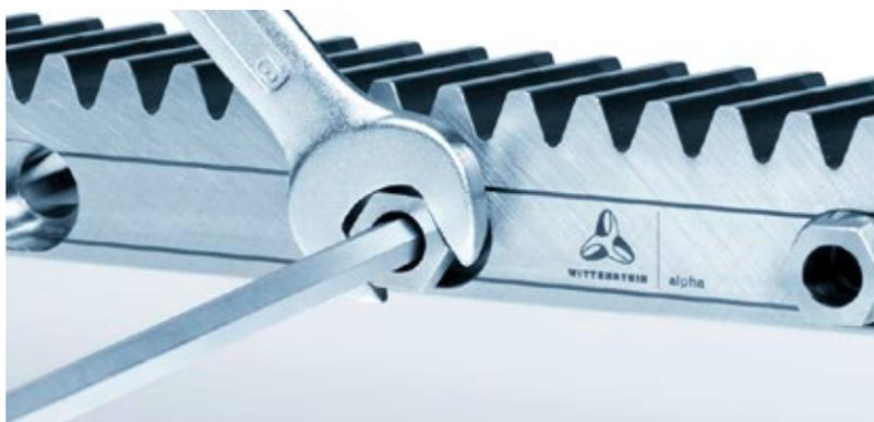
従来、ねじクランプを使用してマシンベッドにラックをクランプ止めするには大変な労力が必要でした。INIRA® クランピングは、クランピング装置をラックに組み込んでいます。このラックには据付用スリーブが組み込まれ、これが固定用ねじのヘッドの上部にガイドされることで、迅速かつ人間工学的なクランピングが実現します。
