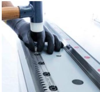
据付ピンは隣接するコンポーネントの製造時に開けられたピン穴に打ち込まれます。
