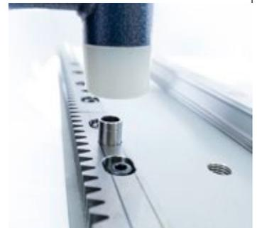
据付スリーブはその後、ハンマーを使用して表面が揃う位置まで打ち込みます。
