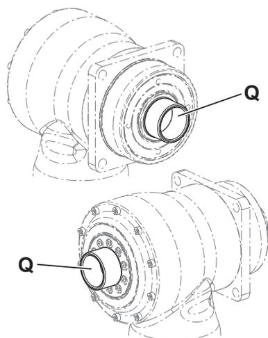
Il calettatore serve al fissaggio di un riduttore con albero con codolo per calettatore / albero cavo / albero cavo con codolo per calettatore [Q] all'albero di carico.
