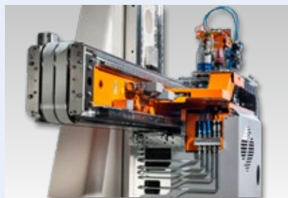
Transferencia de prensa Fuente: Strothmann Machines & Handling GmbH
