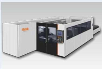
Láser de plataforma plana Fuente: Yamazaki Mazak Corporation
