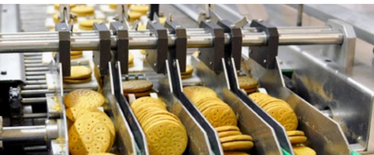
Zoetigheden – verpakkingsinstallatie voor koekjes
