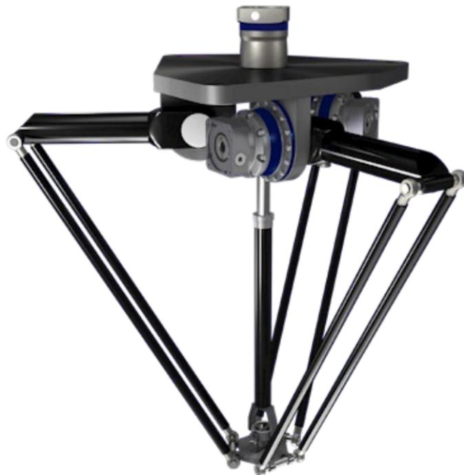
Планетарный редуктор DP+ был специально разработан для применения в механизмах Delta-роботов. Различные виды исполнения позволяют использовать его в сухих и влажных зонах, а также в зоне брызг (HDP+). Наряду с оптимизированной системой уплотнений преимущества этого приводного решения заключаются также в более высокой динамике благодаря версии с оптимизированным моментом инерции. DP+ доступен в четырех типоразмерах и охватывает диапазон передаточных отношений  $i = 16-55$ .
